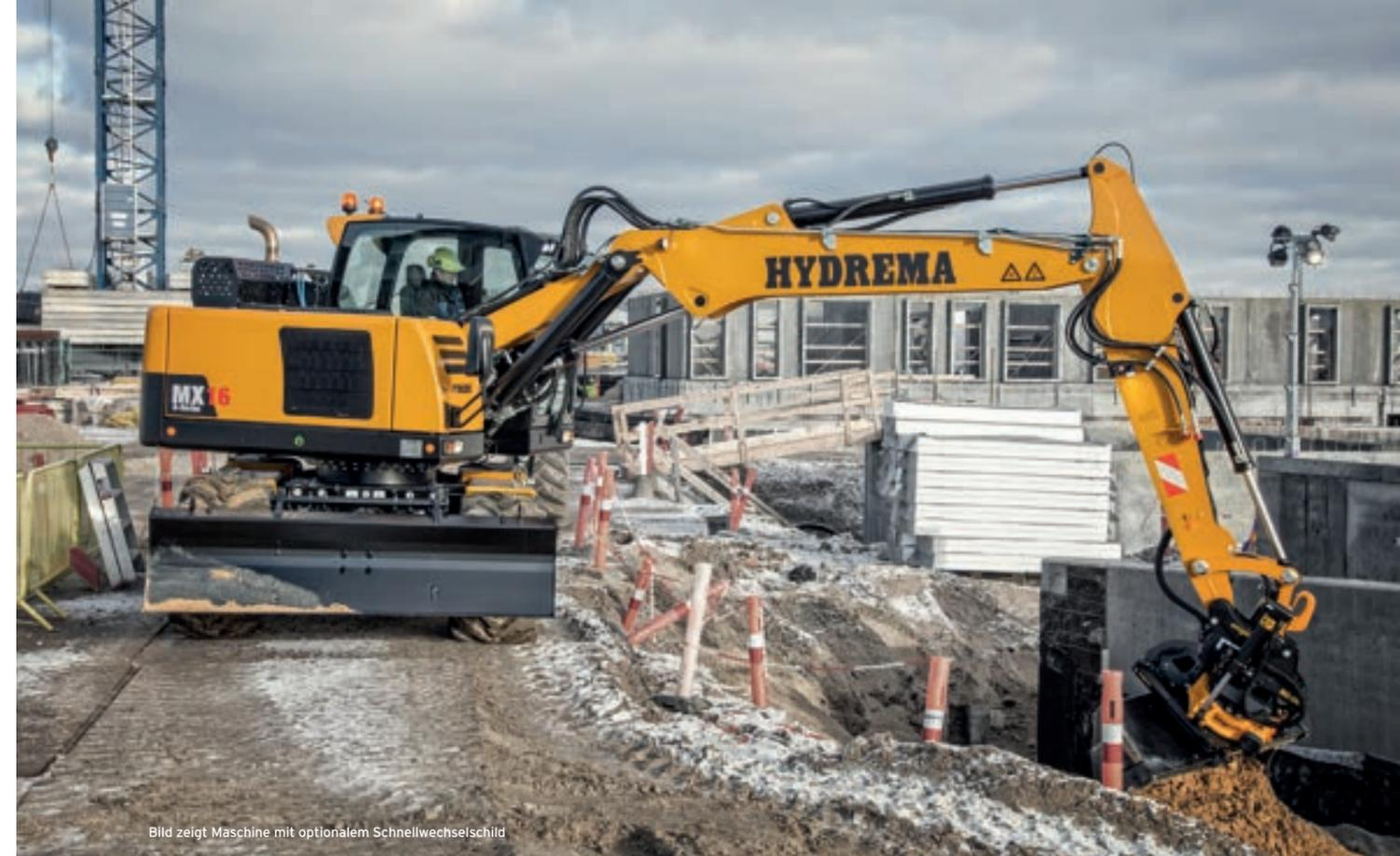
Bild zeigt Maschine mit optionalem Schnellwechselschild
