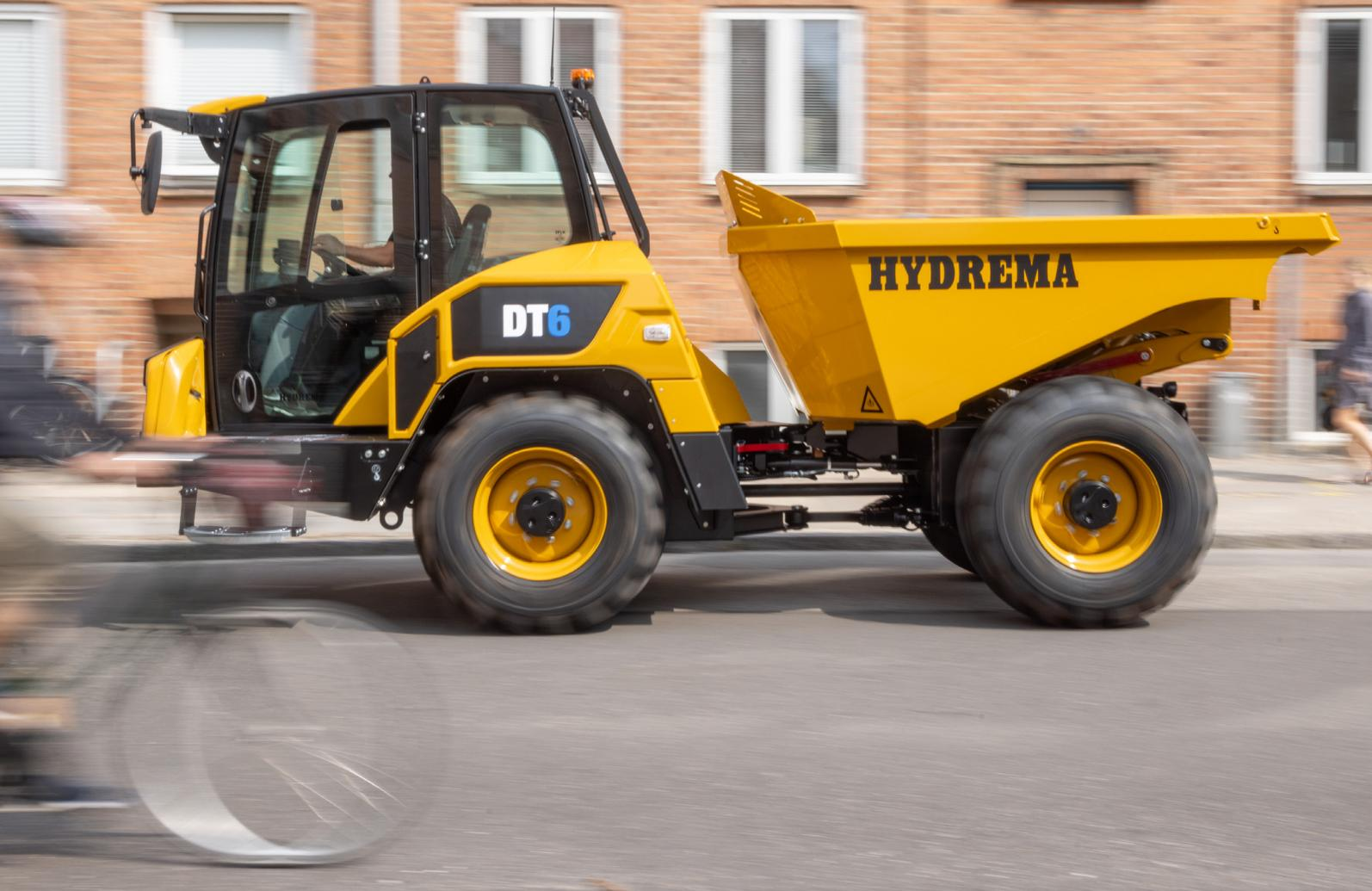
Der neue vollelektrische, knickgelenkte Muldenkipper. Der DT6 kombiniert einen elektrischen Direktantrieb mit bedarfsgesteuerter Hydraulik. Konstruiert mit denselben Features wie die bewährten Hydrema Muldenkipper.
